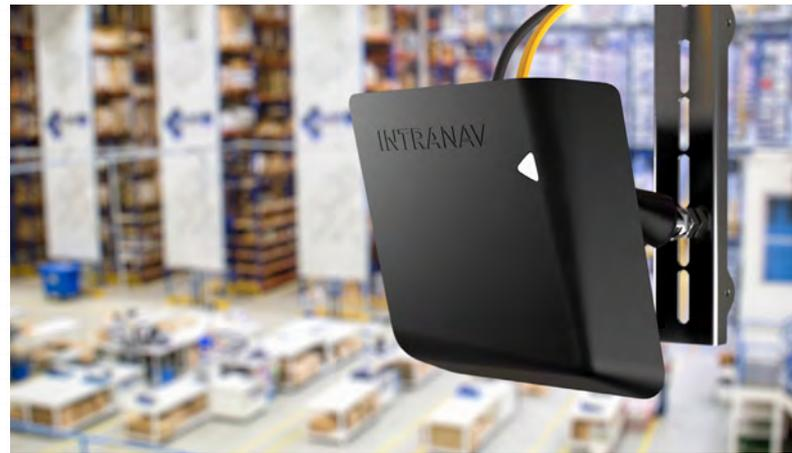
mationen ausgeben. Im Vergleich zu WLAN oder GPS ist die Ortungsgenauigkeit mit **INTRANAV** UWB bis zu 150 x genauer (15m zu 10cm). Auch Bluetooth ist hier mit 3m Genauigkeit noch zu unpräzise.
